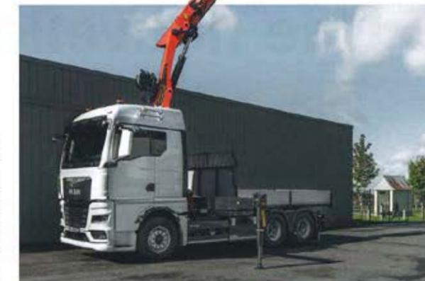
L'échappement, les réservoirs de carburant et d'AdBlue, le réservoir de pression ou le caisson des batteries peuvent être déplacés en cas de besoin dès la fabrication en usine.
