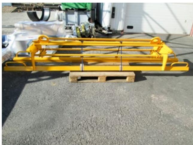
Plusieurs modèles de pinces sont proposés à la vente, avec différentes longueurs de mâchoires (1000mm à 3500mm), des capacités de levage allant de 2000 Kg à 4500 Kg et différents modes de préhension (anneaux, rotators...)
